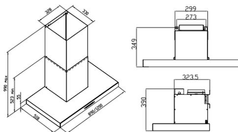
1. 機身底部至掛勾螺絲鑽孔高度 349mm
